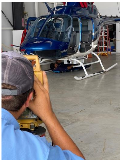
Figura 11: Muestra de mediciones de precisión para la Calibración de la instalación del Equipo
