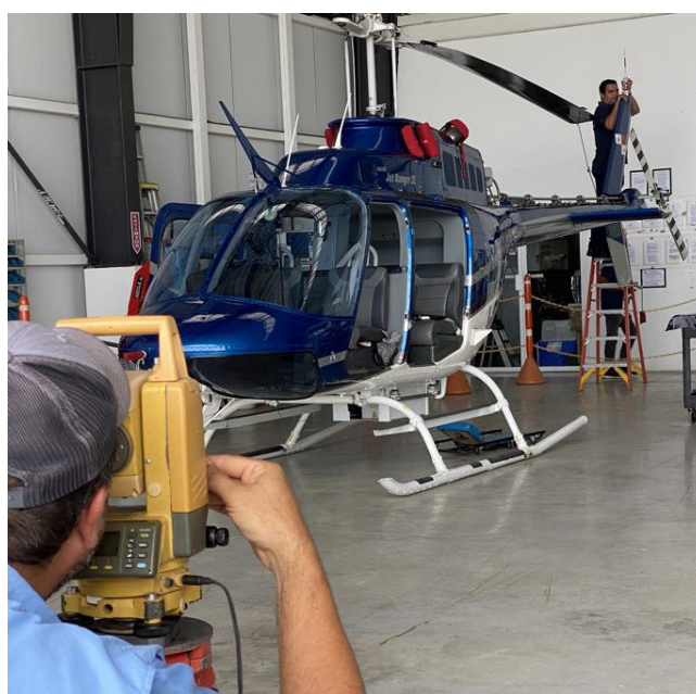
Figura 13: Muestra de mediciones de precisión para la Calibración de la instalación del Equipo
